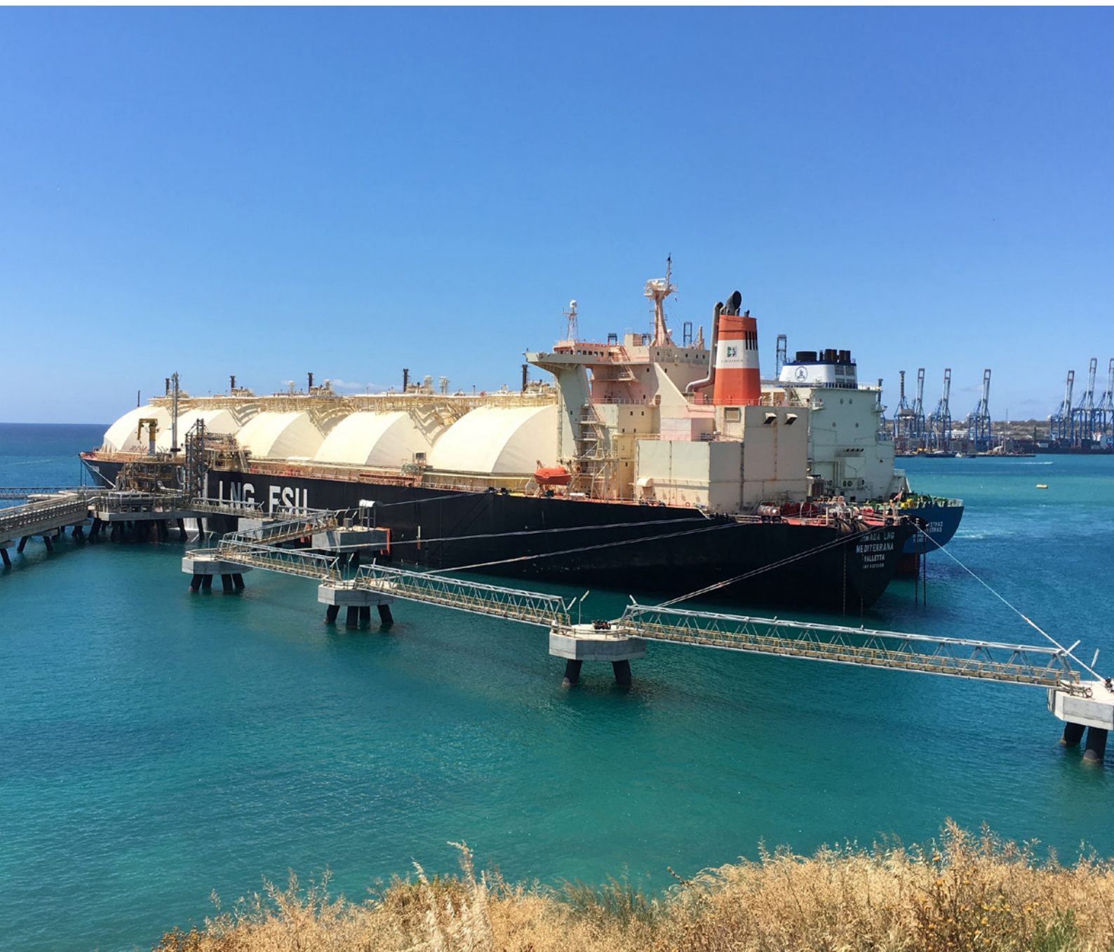
Obr. 6.2 Ukázka námořního LNG terminálu na Maltě vybudovaného z LNG tankeru, zdroj: innogy
