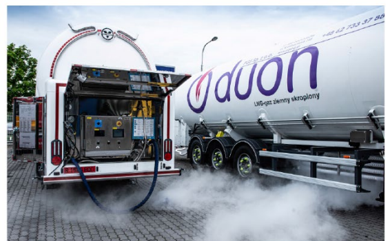
Odpařené oblaky během dodávky LNG Condensed water vapour during fresh LNG supply
